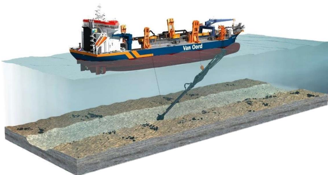
Abbildung 12 Arbeitsschiff zum Herstellen der Liegewanne und des Zufahrtbereiches (Beispiel)
