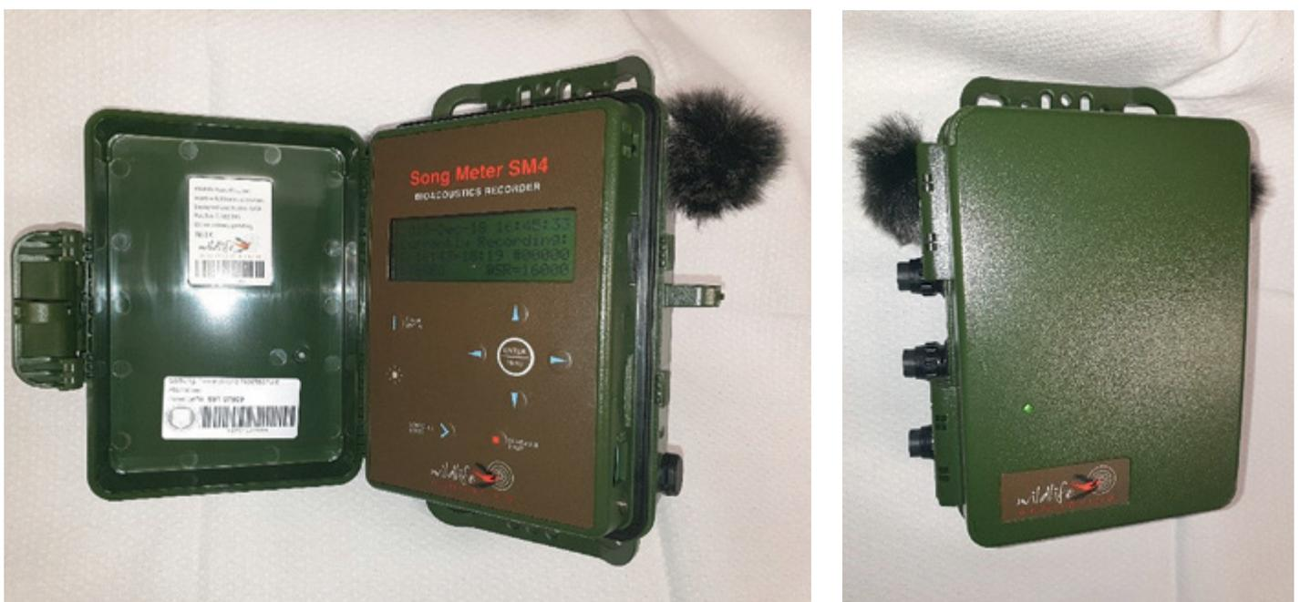
Abb. 30: Akustikrekorder Songmeter SM4, Wildlife Acoustics USA; links geöffnet (Foto: O. Keuling)
