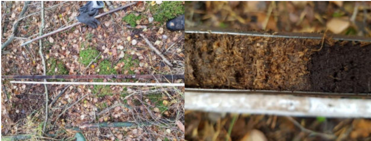
Abbildung 2: Bohrstocksondierung in Waldgebiet: links: Gesamtes Bodenprofil; rechts: Wechsel von Vererdungsschicht zu Weißtorf, In Detailaufnahme
