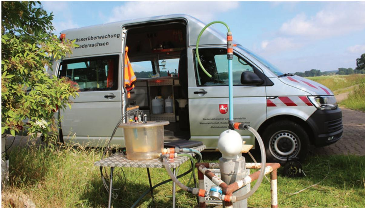
Abb. 49: Durchführung einer qualifizierten Grundwasserprobenahme.
