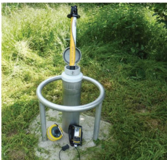
Abb. 50: Datensammler mit Datenfernübertragung, Lichtlot zur Handmessung, RDS-Recon zum Auslesen des Datensammlers.
