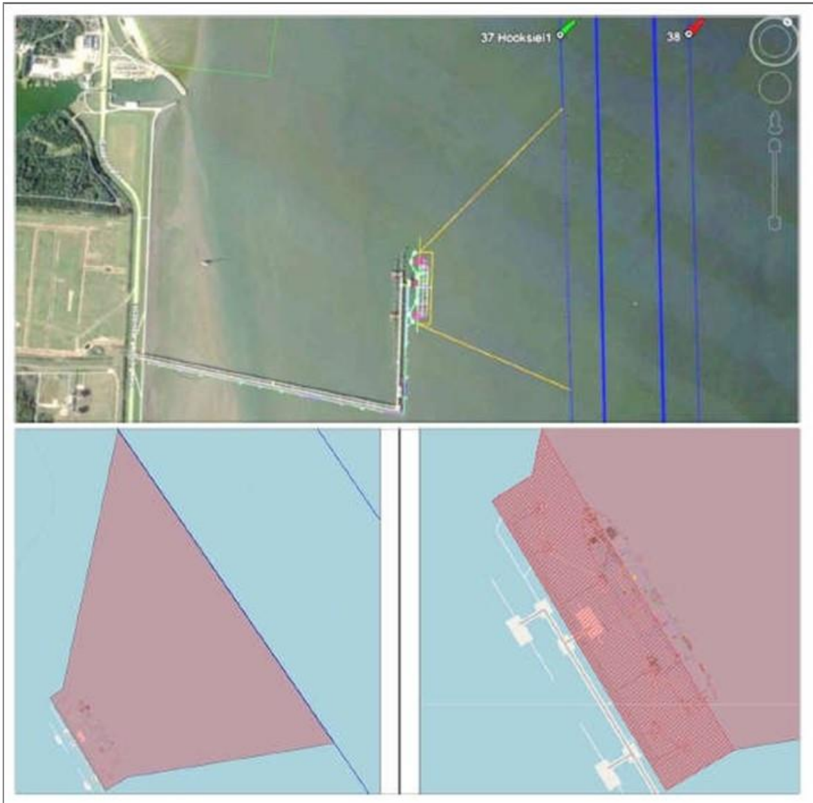
Abb. 10 Sondierfläche (hellrot) mit angepasstem Vorgehen in Bestandsnähe (rot schraffiert)
