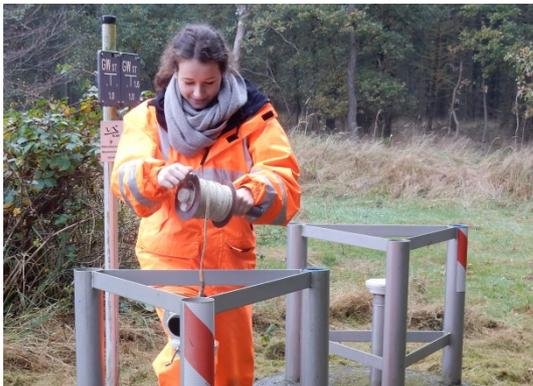
Abb. 34: Grundwasserstandsmessung mit dem Lichtlot.
