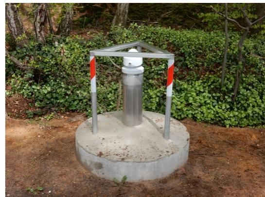
Abb. 33: Fertiggestellte Messstelle mit Sicherheitsdreieck.
