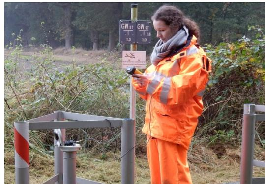
Abb. 35: Überprüfung der DFÜ-Sonde.
