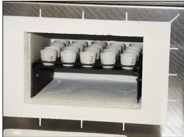
Abbildung A1: Sedimentproben für den thermischen Aufschluss bei 450 °C für 3 h.
