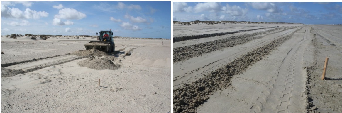
Abb. 4 Beprobung der Flächen durch einen Radlader
