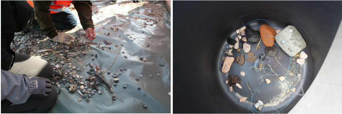
Abb. 5 händische Sortierung des Siebguts
