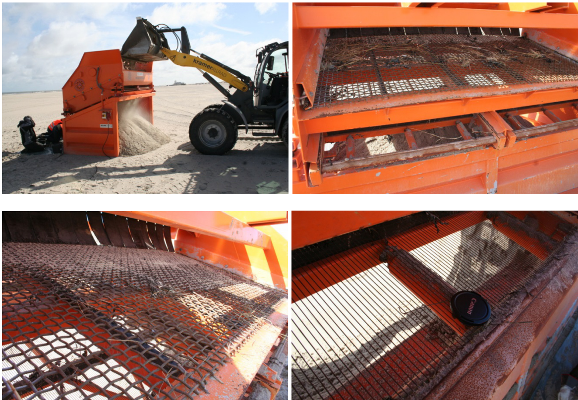
Abb. 3 Siebmaschine (Maschenweite unteres Sieb: 0,6 cm)
