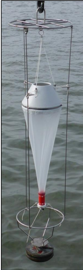
Abbildung 2: Aufbau des benutzten Zooplanktonnetzes.
