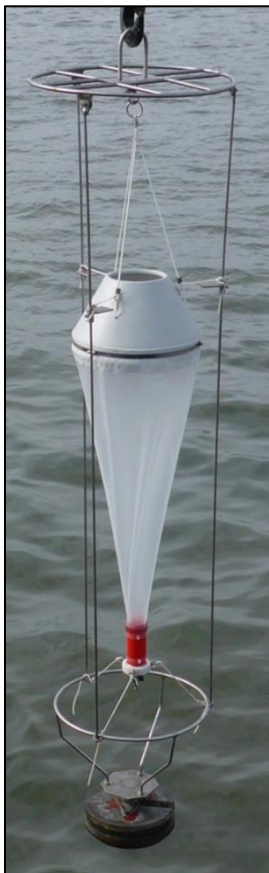
Abbildung 2: Aufbau des benutzten Zooplanktonnetzes.
