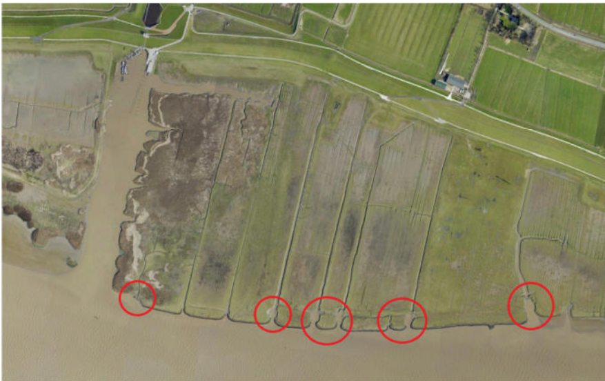
Abbildung 6: Abbruchkanten des Petkumer Deichvorlands
