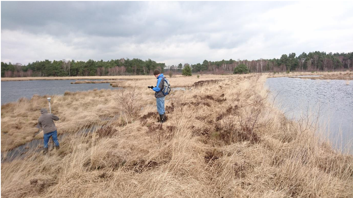
Abbildung 2-6: Unterschiedliche Wasserstände im Teilgebiet Rehburger Moor - ÖSSM-Mitarbeiter bei einer Höhenmessung; links im Bild der zentral im TG Rehburger Moor liegende See, dessen Wasserspiegel deutlich niedriger liegt als der Wasserspiegel in den östlich angrenzenden überstauten Flächen (rechts im Bild)
