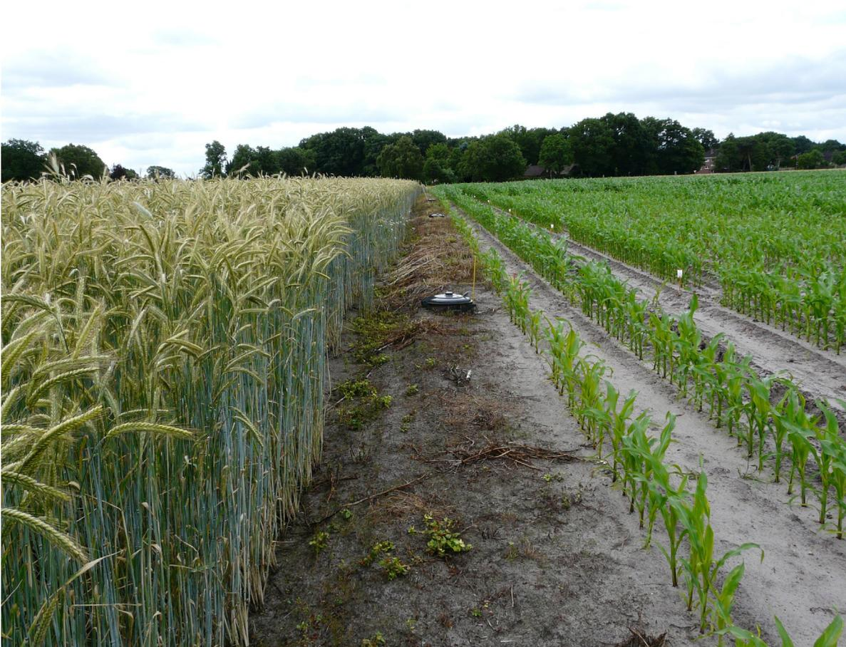
Abbildung 39: Wie sich die Düngung auf die Nitratwerte im Sickerwasser auswirkt, kann mit Hilfe von Sickerwassermessstellen wie hier (Versuchsfeld der Landwirtschaftskammer Niedersachsen in Wehden) überprüft werden. Links neben der Maisreihe sind die Messgefäße im Boden zu sehen (Foto: Bauer).
