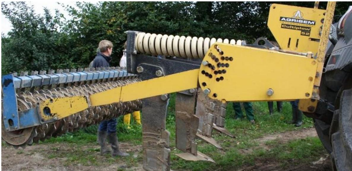
Abbildung 17: Mit einem Tiefengrubber lassen sich Verdichtungen im Unterboden aufllockern (Foto: NLWKN).
