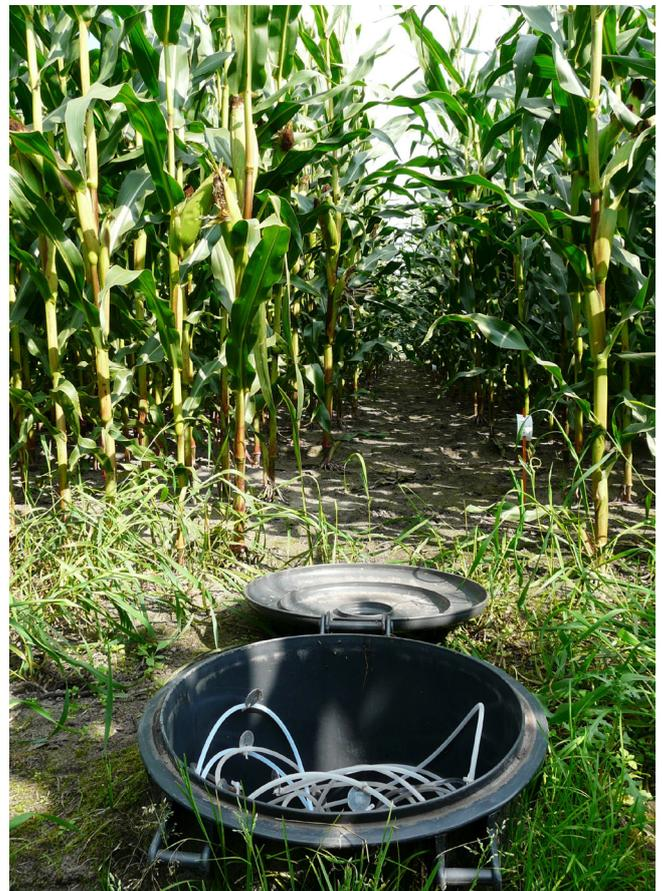
Abbildung 38: Mit dieser Sickerwasser-Anlage kann ein Nitrat-Tiefenprofil erstellt werden (Foto: Bauer).
