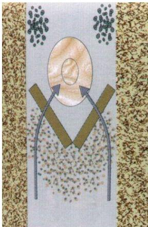
Ein Beispiel für Tothholz-Einbauten, die zusätzliche Sohlstrukturen schaffen, ohne die Ufer anzugreifen sind bachaufwärts weisende, v-förmige Tothholz-Swellen. Sie sollten nur wenig über die Niedrigwasserlinie ragen, damit bei höheren Wasserständen die Strömung nicht gegen die Ufer gelenkt wird. Unterhalb der Tothholz-Schwelle bildet sich ein Kolk in der Gewässermitte.
