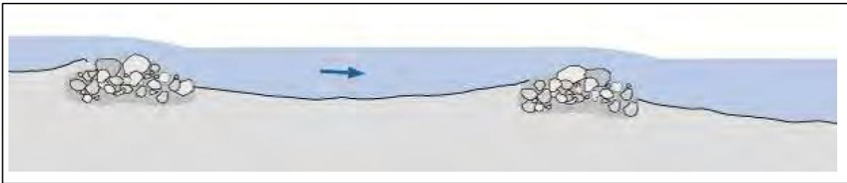
Abb. 3.5: Prinzipskizze einer Stützschwelle im Längsschnitt (DWA, 2014)
