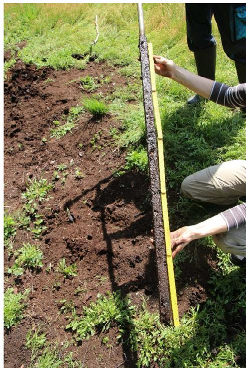
Abbildung 7: Gutsbohrer im Einsatz
