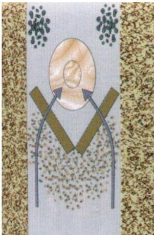
Ein Beispiel für Totholz-Einbauten, die zusätzliche Sohlstrukturen schaffen, ohne die Ufer anzugreifen sind bachaufwärts weisende, v-förmige Totholz-Swellen. Sie sollten nur wenig über die Niedrigwasserlinie ragen, damit bei höheren Wasserständen die Strömung nicht gegen die Ufer gelenkt wird. Unterhalb der Totholz-Schwelle bildet sich ein Kolk in der Gewässermitte.
