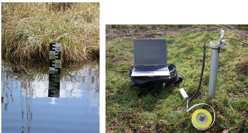
Abb. 20: Wasserstandmesseinrichtungen für ein hydrologisches Messnetz.
