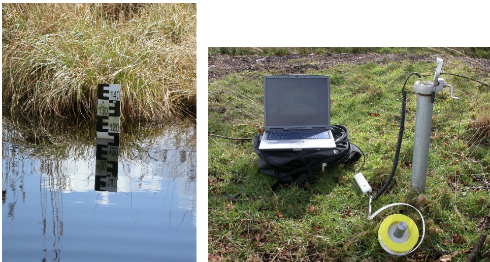
Abb. 21: Wasserstandmesseinrichtungen für ein hydrologisches Messnetz.
