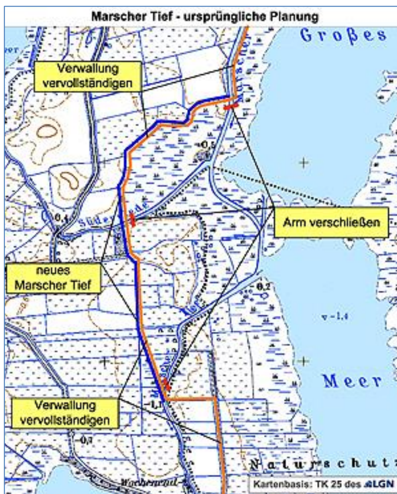
Abb. 27: Marscher Tief – ursprüngliche Planung einer Verlegung 13
