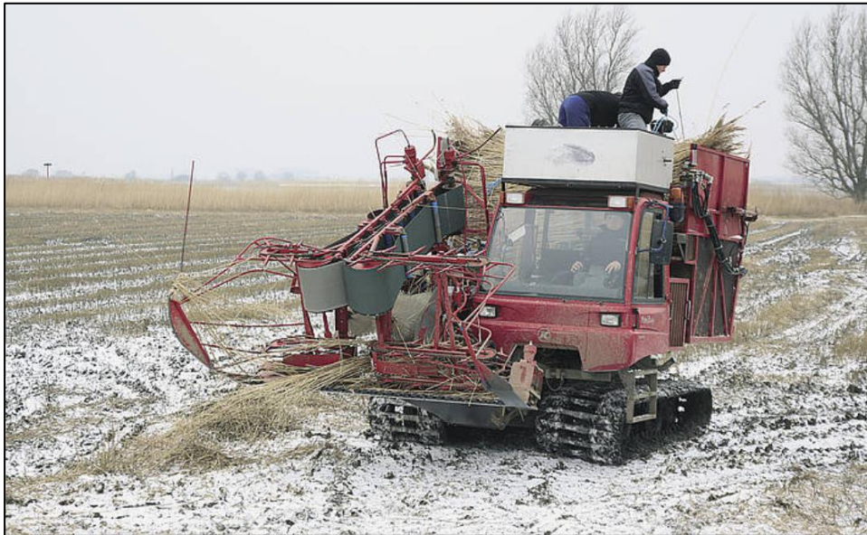
Foto 20: Reetschneiden 2020 mit umgebautem Pistenbully (Wesermarsch). 30
