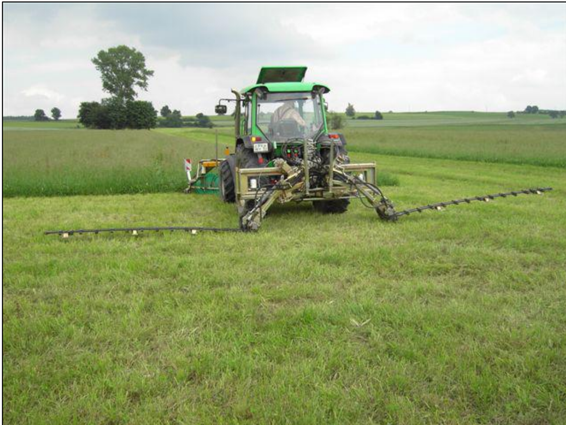
Foto 21: Modernes Doppelmesser-Mähwerk (aus BfN 2014)
