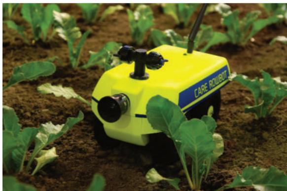
Abb. 11-2: Autonome Kleinstmaschine im Rübenbestand „smart farming“ (Foto Julius Kühn-Institut)
