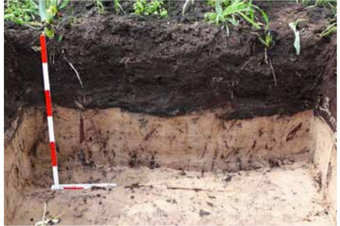
**Abb. 23: Beispiel für eine Fehleinschätzung des Humusgehalts im Oberboden (0 bis 30 cm) nach Humusfarbe (Fotos: INGUS)**
