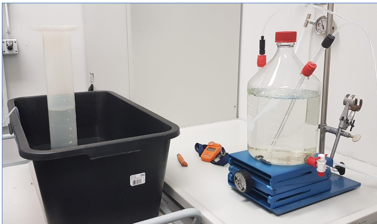
Abbildung 12: Volumenstromermittlung im Zu- und Ablauf des Reaktionsbehälters
