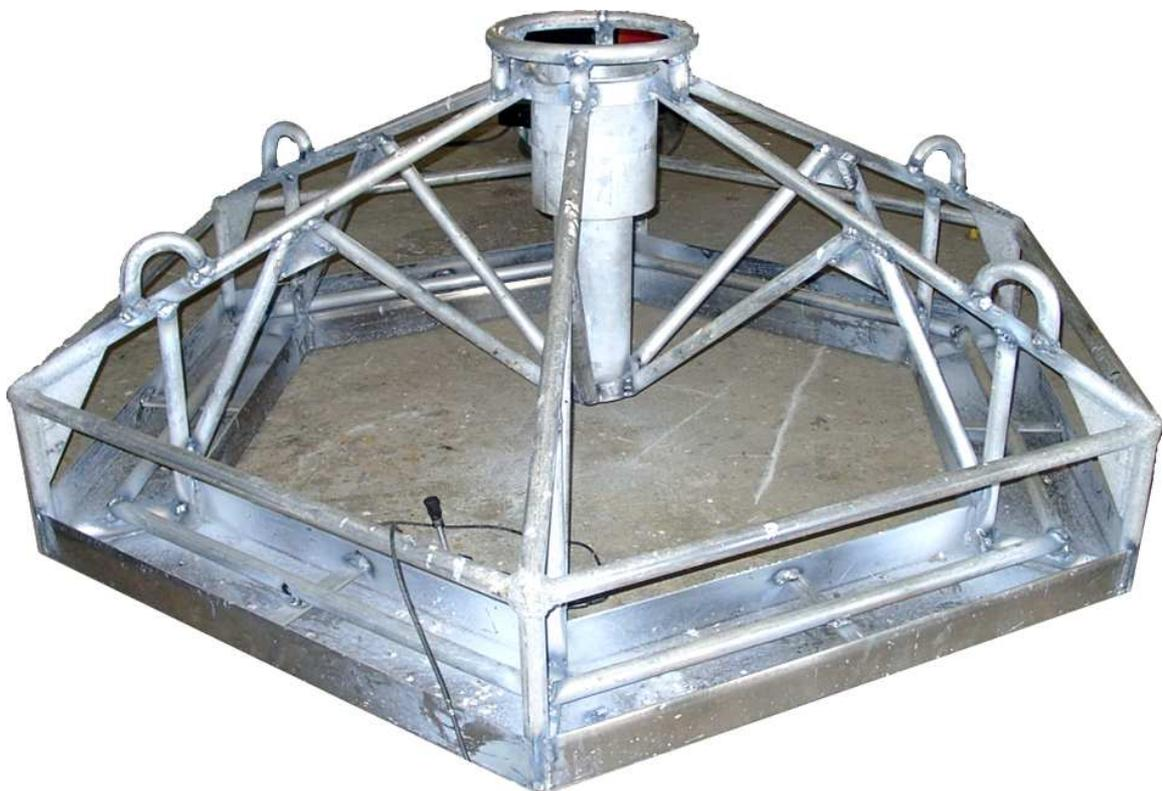
Abbildung 5.1: Gestell für die ADCPs an den Standorten Düneros Pos. 2 und Pos. 3, hier noch ohne die Betonauffüllung im unteren Ring
