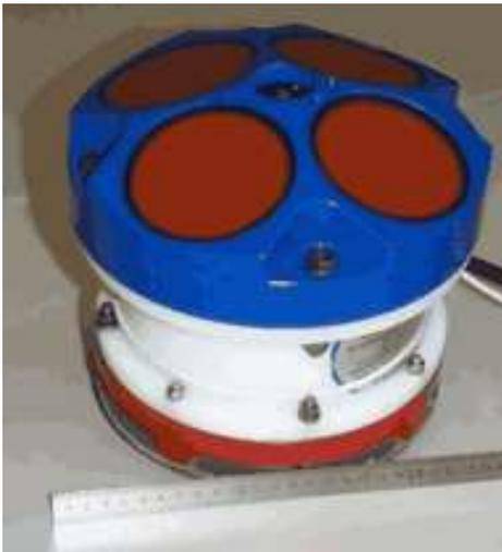
Abbildung 3.2: ADCP Modell Workhorse Rio Grande (600 kHz), (RD Instruments)
