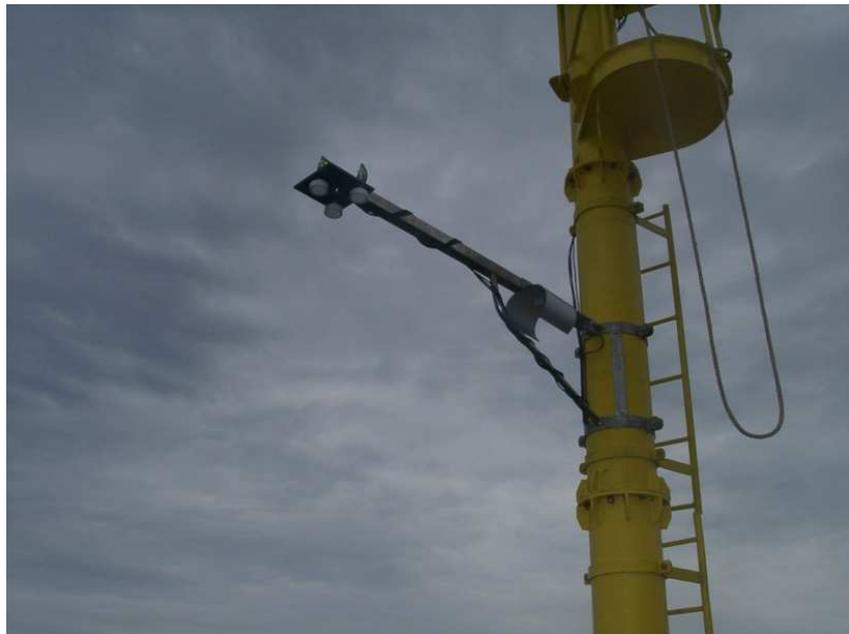
Abbildung 3.8: Log-A-Level-Sensoren an Position Düneros4
