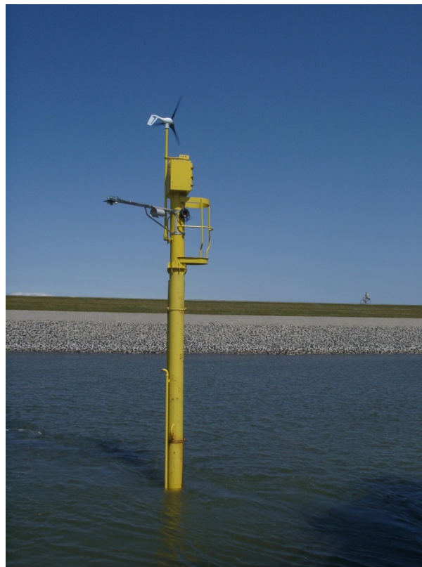
Abbildung 5: GA-Pegel mit Windrotor vor Norderney
