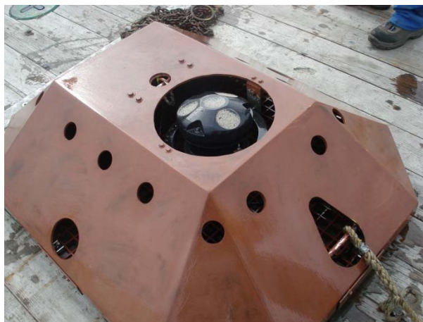
Abbildung 3: AWAC-Messgerät im Schutzkasten
