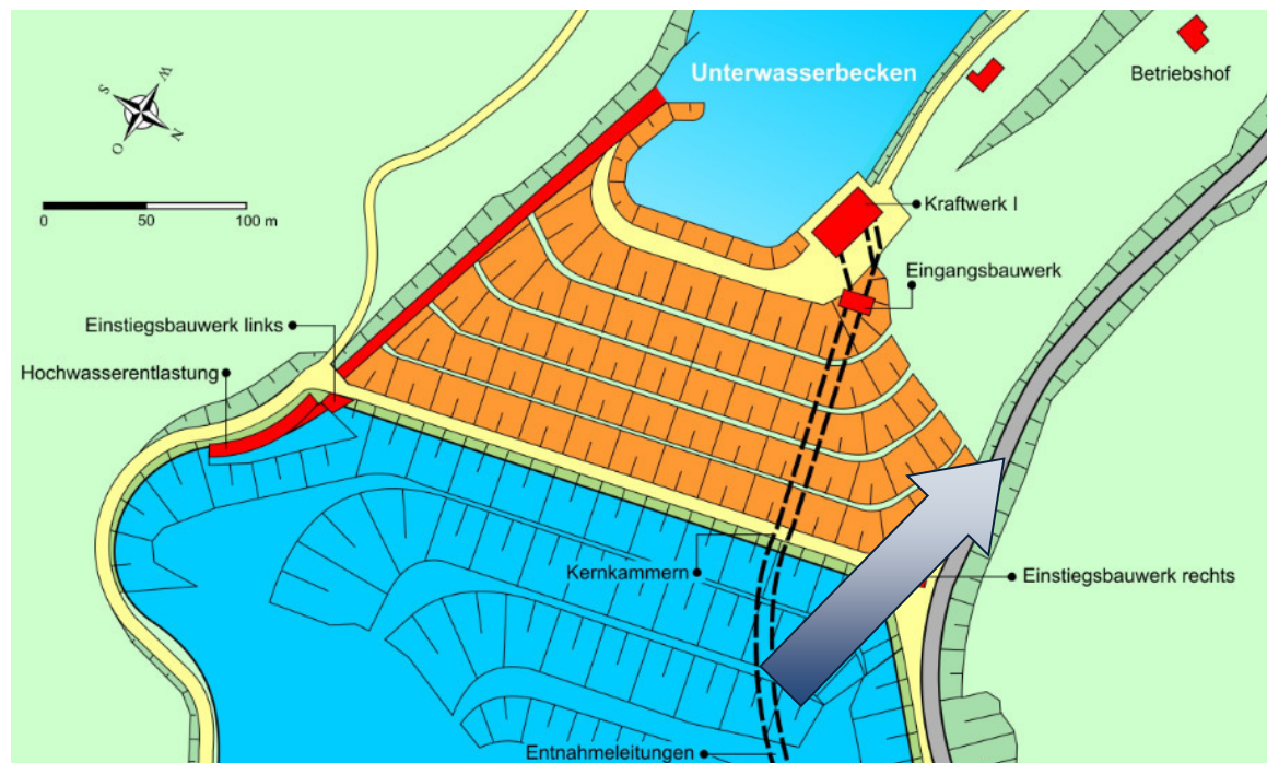
Abb. 2 Fließrichtung des Wassers bei Überflutung der Talsperre
