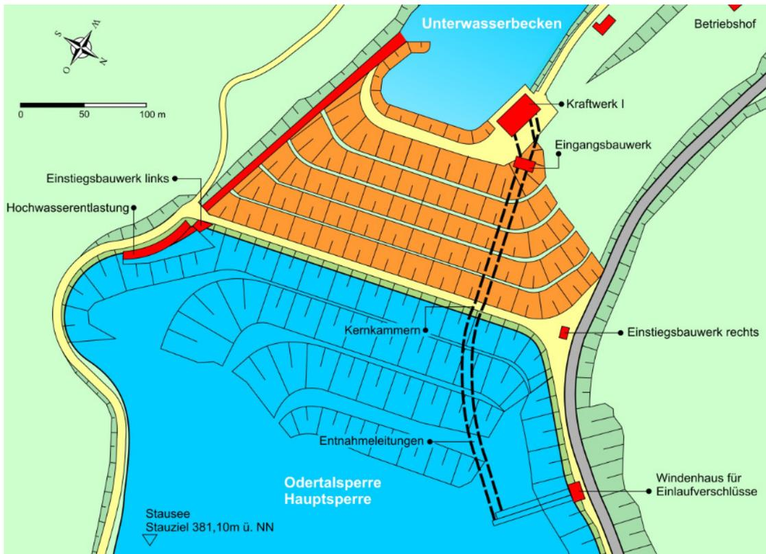
Abb. 42 Odertalsperre Hauptsperrre Lageplan Entnahmeleitungen
