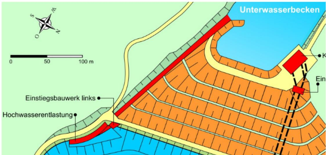
Abb. 43 Odertalsperre Hauptsperre Lageplan Hochwasserentlastungsanlage
