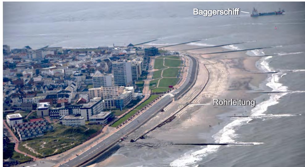
Abb. 5: Westkopf der Insel Norderney mit der Spülleitung der Strandaufspülung 2012
