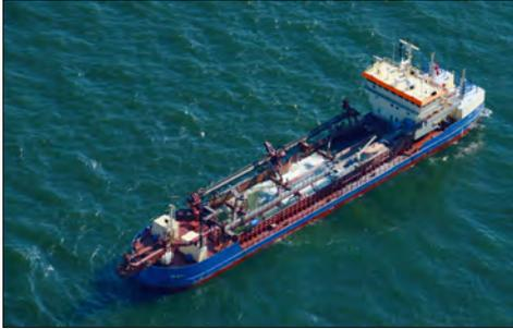
Abb. 3: Baggerschiff, das den Sand an der Robbenplate entnimmt und zur Koppelstation transportiert
