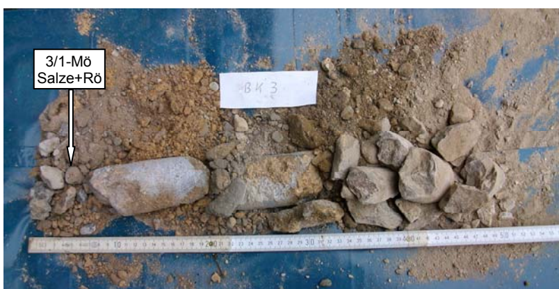
Bild 21: Bohrkern 3 BK 3/1: 0– 8 cm = loser Mörtel BK 3/2: 8 – 20 cm = Kalkstein, z. T. Mörtel BK 3/3: 20 – 31 cm = loser Mörtel + ½ Stein/Granit + Kalksteinstücke BK 3/4: 31 – 50 cm = loser Mörtel + Kalksteinstücke
