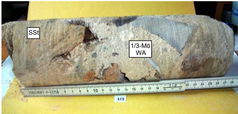
Bild 7: BK-Abschnitt 1/3 (42-70 cm) zu Bild 4 um 90° gedreht; daraus Kalkstein-Probe
