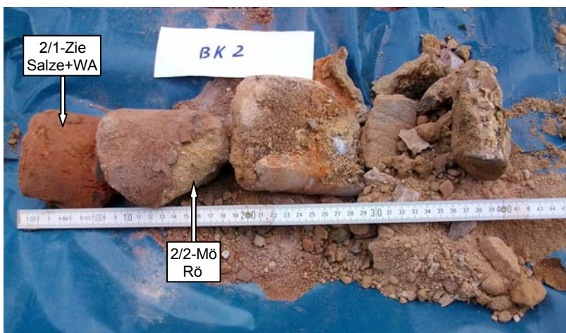
Bild 15: Bohrkern 2 BK 2/1: 0 – 8 cm = Ziegelstück + Mörtelfuge BK 2/2: 8 – 19 cm = Mörtel und verschiedene angeschnittene Steine BK 2/3: 19 – 29 cm = Mörtel + Sandstein (innen) BK 2/4: 29 – 40 cm = Stein- und Mörtelteile
