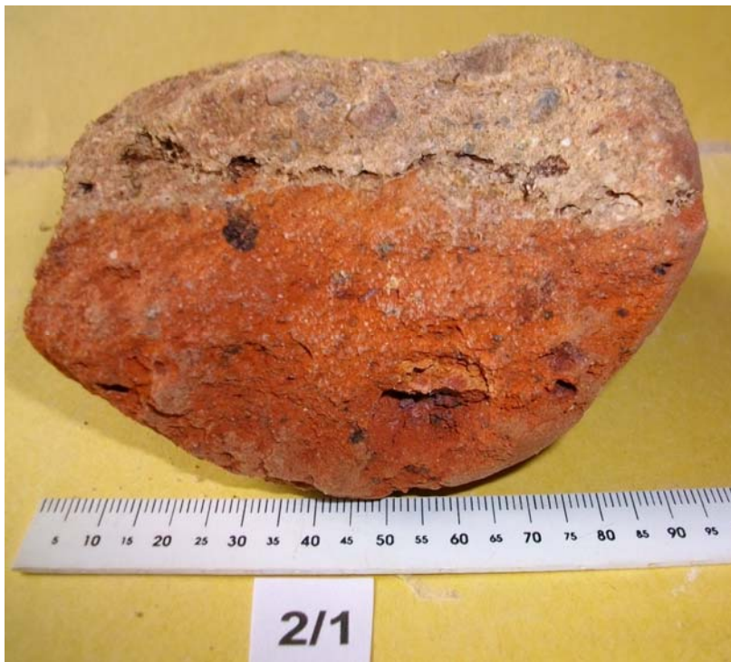
Bild 16: BK-Stück 2/1; siehe Bild 15; daraus Proben 2/1-Ziegel für Salzbestimmung und Wasseraufnahme
