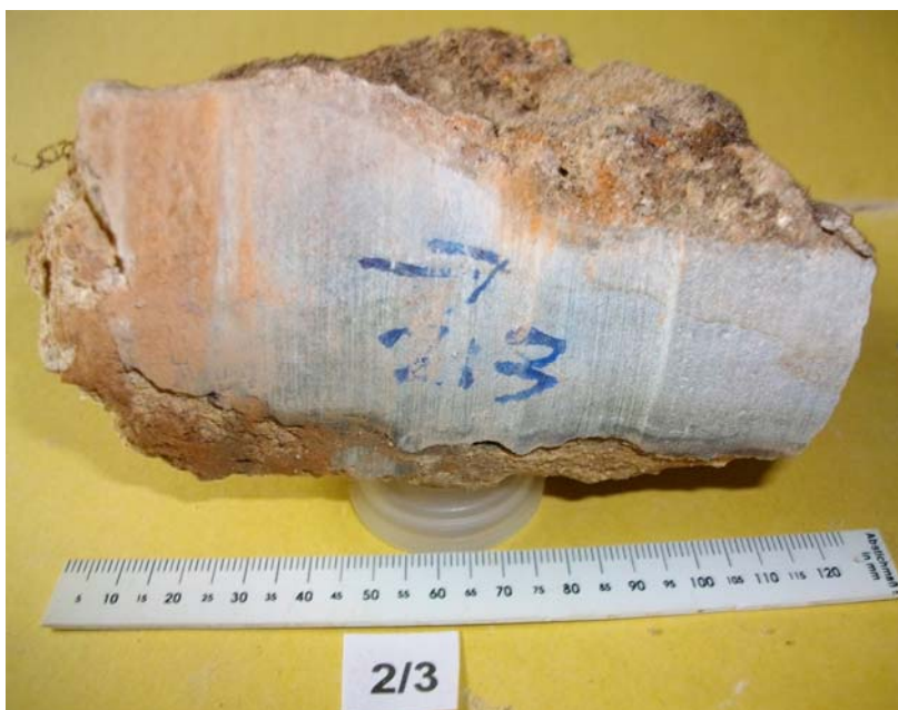
Bild 17: BK-Stück 2/3; siehe Bild 15; aus dem Inneren Probe 2/3-Sandstein für Wasseraufnahme
