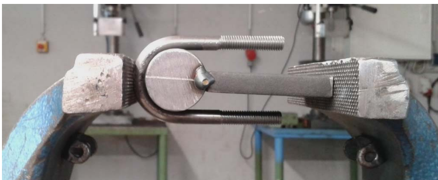
Abb. 3: Biegehilfe im Schraubstock (Seitenansicht)
