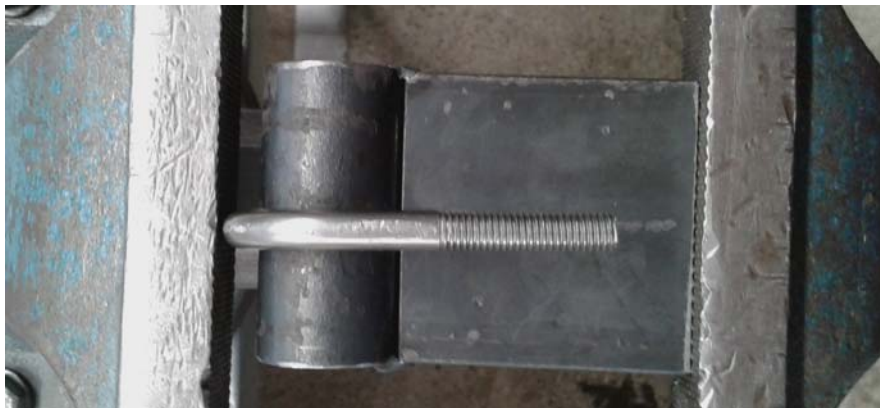
Abb. 2: Biegehilfe im Schraubstock (Draufsicht)
