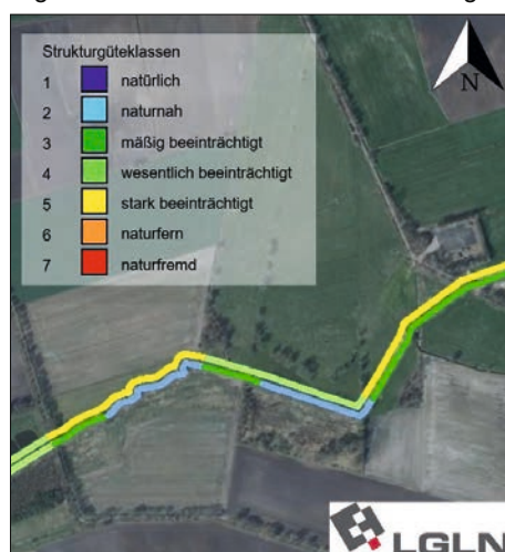
Detailstrukturen am Lünzener Bruchbach: Vergleich vor (2011, Band oben) und nach (2015, Band unten) der Maßnahmenumsetzung Quelle: Dr. T. Eggers
