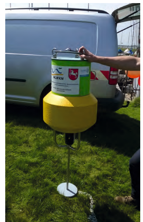
Die geschlossene Schaumstruktur schützt die Messtechnik der YSI EXO2-Multiparametersonden.
