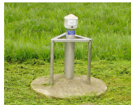
Auch die Messstelle Emmerstedt ist mit Datenfernübertragung ausgestattet.
