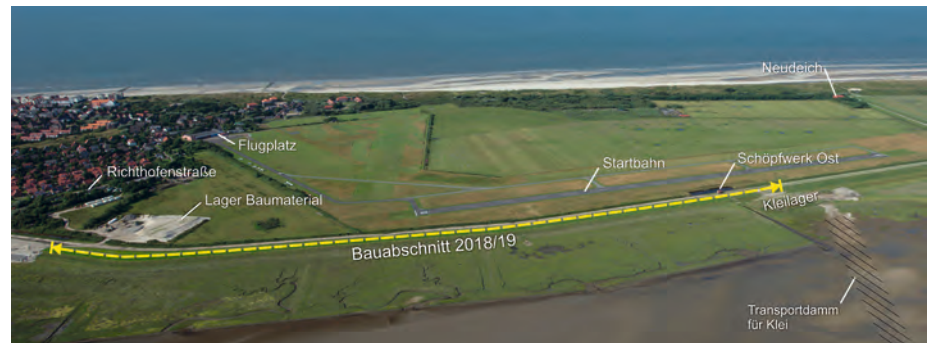
Sie hebt den Insel-schutz für Wangerooge auf ein neues Niveau: Die über fünf Jahre vorangetriebene Erhöhung und Verstärkung des Dorf- und Ostgroden-deiches geht in 2019 in ihre finale Bauphase. Bild: Stromann/SKN
