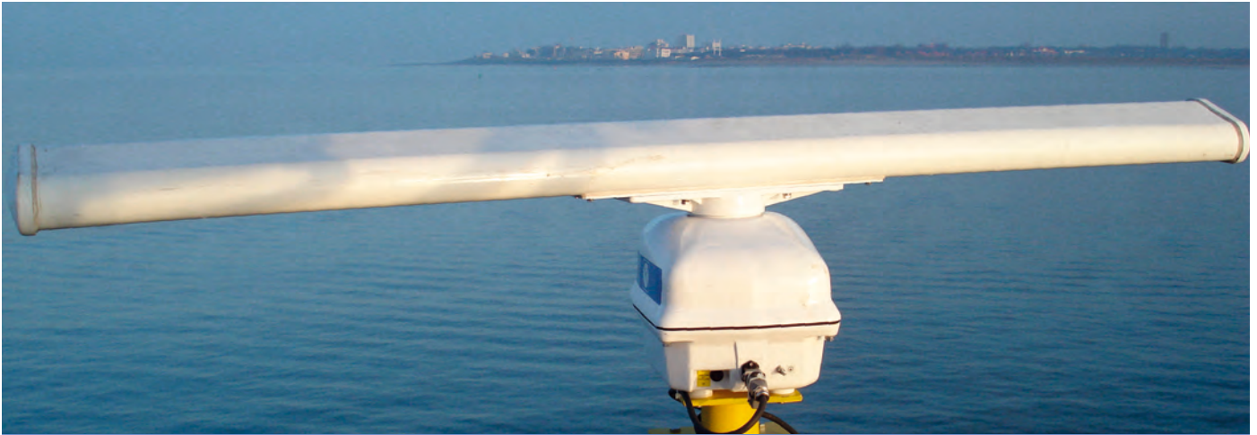
Liefert fortlaufend wertvolle Daten zur Erfassung der Seegangsausbreitung im Norderneyer Seegat: Die 2018 neu eingerichtete Dauermessstation auf dem Messturm Steinplate im ostfriesischen Wattenmeer.
