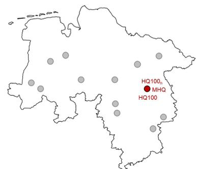
Rückskalierung des geschätzten, normierten Hochwasserquantils der gesuchten Jährlichkeit ( $HQ_n(T)$ ) mittels geschätztem mittleren Jahreshochwasser ( $MHQ$ ) zu geschätztem Hochwasserquantil der gesuchten Jährlichkeit ( $HQ(T)$ )
