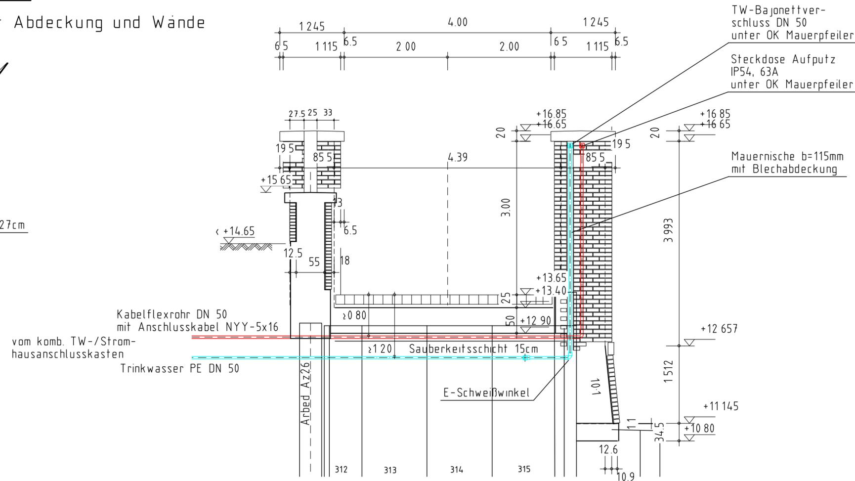
Schematische Darstellung der Wanddurchführungen für die Strom- und Trinkwasseranschlussleitung am Durchgang 4 (Deichschart 3)
