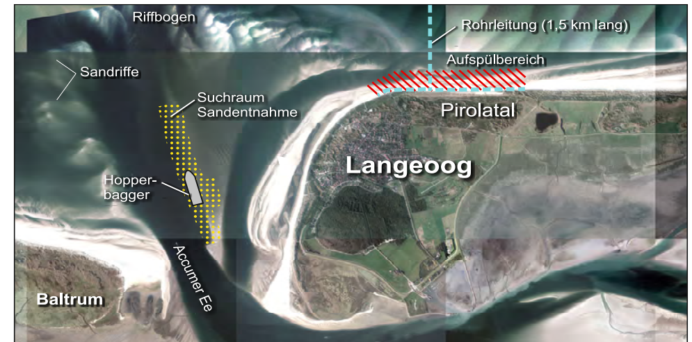
Abb. 2: Küstenparalleler Sandtransport und Übersichtsplan Strandaufspülung
