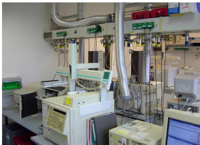
Abbildung 12: Untersuchung auf organische Spurenstoffe mittels Gaschromatograph
