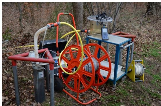
Abb. 61: Gütebeprobung an einer Grundwasser-messstelle.
