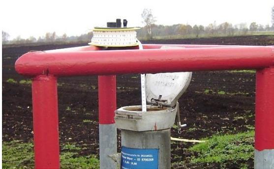
Abb. 65: Grundwasserstandsmessung mit dem Lichtlot.
