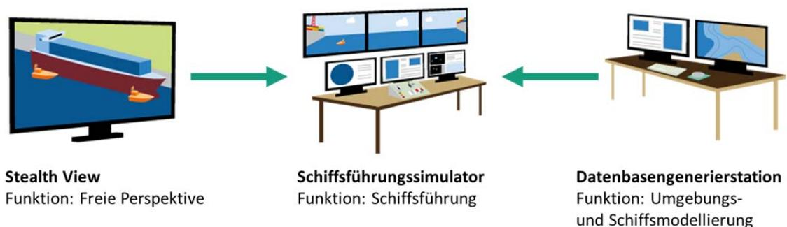
Abbildung 3: Schematischer Aufbau des RDE ANS 6000 am Fraunhofer CML
