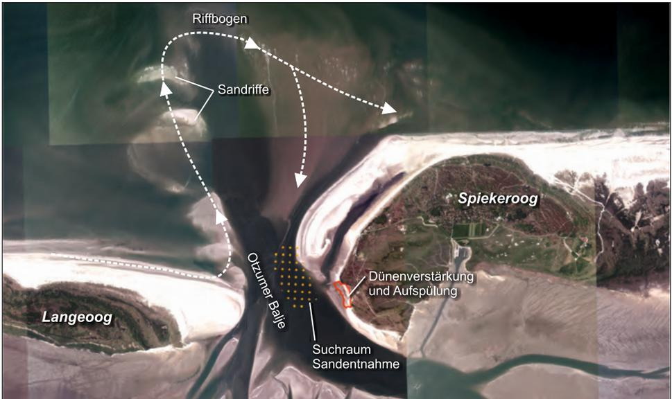
Abb. 2: Sedimenttransport und Übersichtsplan Maßnahme
