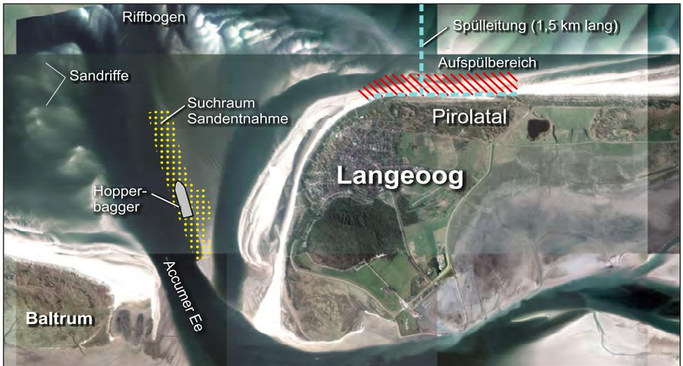
Abb. 2: Küstenparalleler Sandtransport und Übersichtsplan Strandaufspülung
