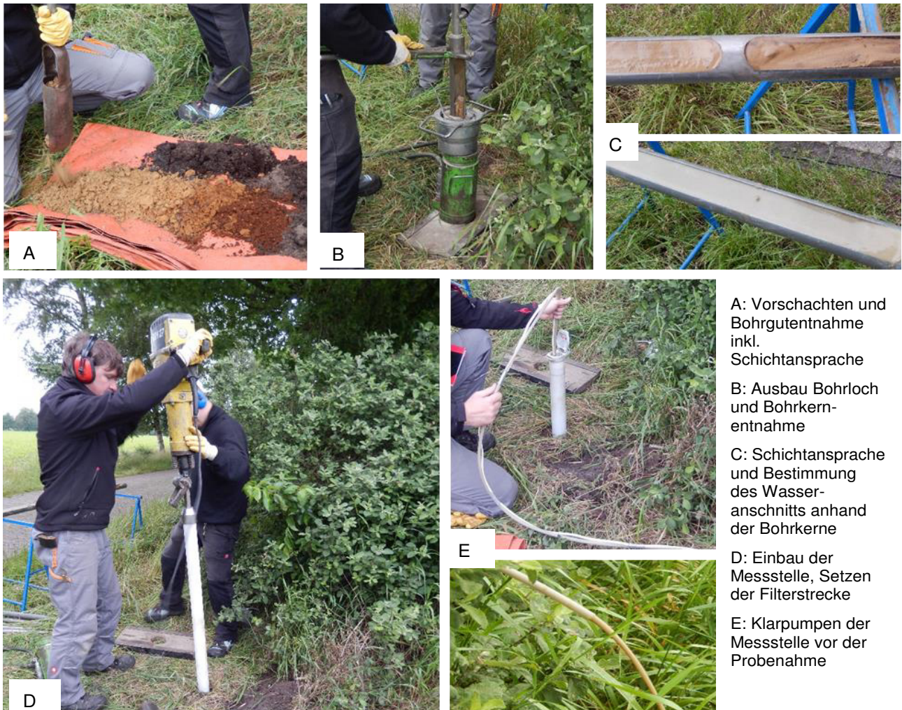
Abb. 13: Bau einer temporären Grundwassermessstelle (TGWM) mittels Rammkernsondierung
