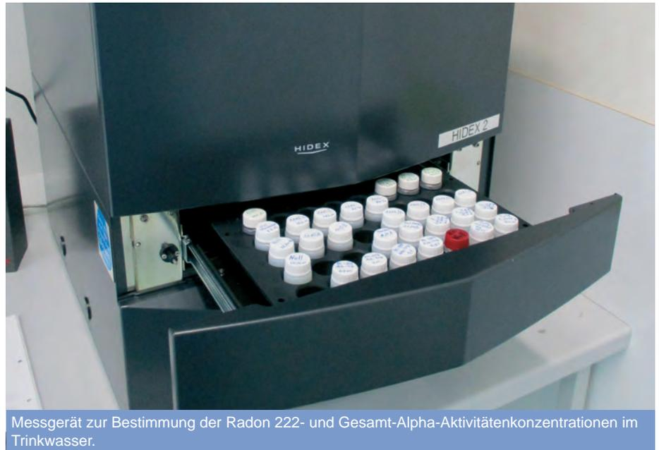
Messgerät zur Bestimmung der Radon 222- und Gesamt-Alpha-Aktivitätenkonzentrationen im Trinkwasser.
