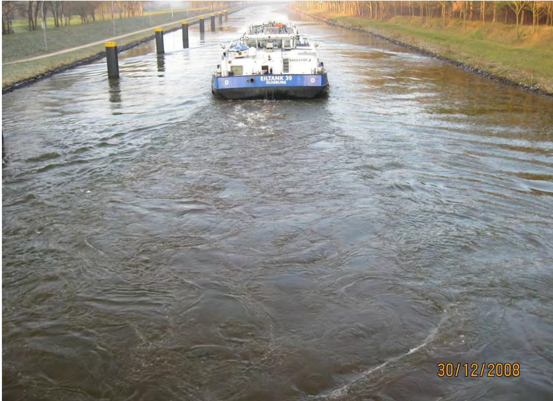
Abbildung 18: Frachter im DEK mit Sunk- und Schwallerzeugung
