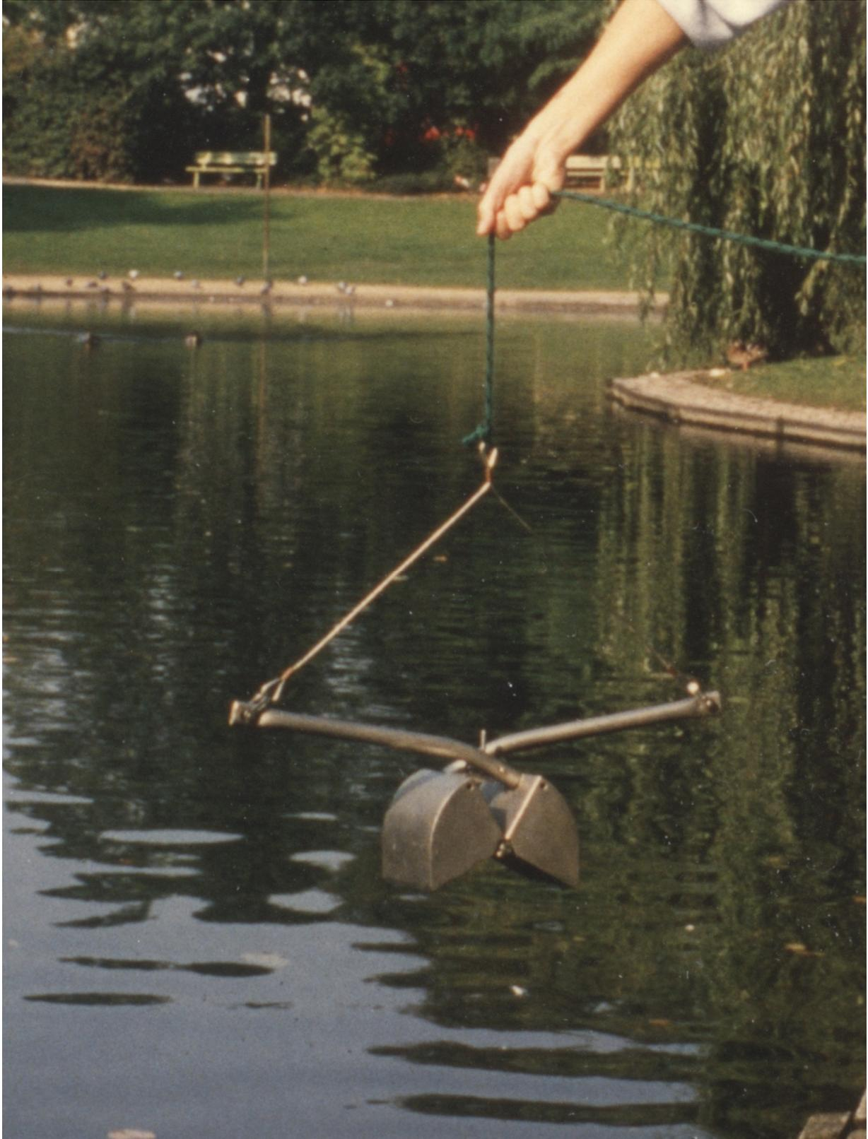
**Abbildung 3:** Sedimentprobenahme mit einem van-Veen-Greifer (Foto: D. Steffen)
