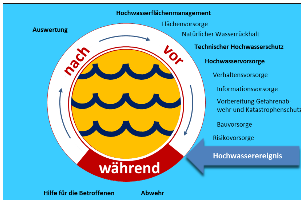
Abbildung 8: Hochwasserrisikomanagement-Zyklus, Darstellung der Phasen vor, während und nach dem Hochwasserereignis (verändert nach "Empfehlungen zur Aufstellung von Hochwasserrisikomanagementplänen" der LAWA ( Bund / Länder AG Wasser))
