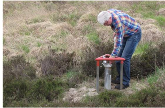
Abb. 54: Grundwasserstandsmessung mit dem Lichtlot.
