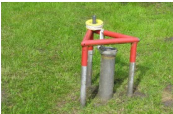
Abb. 57: Grundwasserstandsmessung mit dem Lichtlot.
