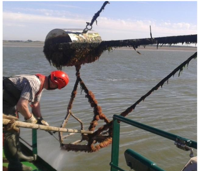
Abb. 3: links: Stark mit Hydrozoen bewachsener Sedimentationskasten im August 2014, Pfeile: Aluminium-Opferanoden; rechts: mechanische Reinigung des Gestänges mittels Hochdruckreiniger (Fotos: T. Behrends)
