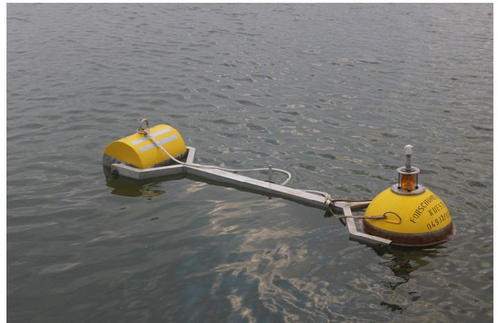
Abb. 2: Bojenkonstruktion mit freihängendem Sedimentationskasten
