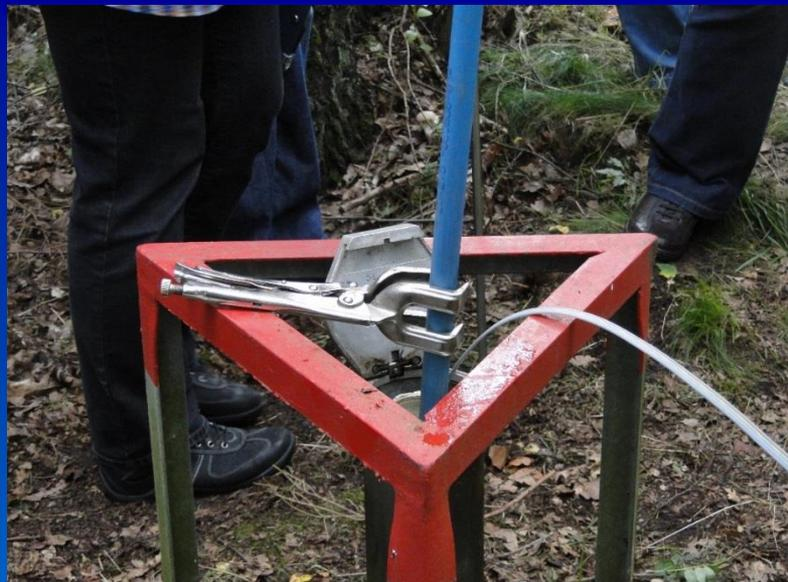
Grundwasserprobenahme an einer Grundwassermessstelle mittels Steigrohr
