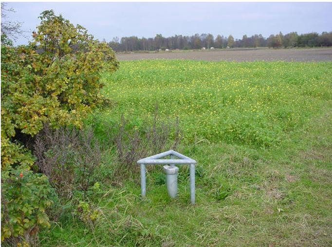
Grundwassermessstelle im Wasserschutzgebiet Aurich-Egels des OOWV
