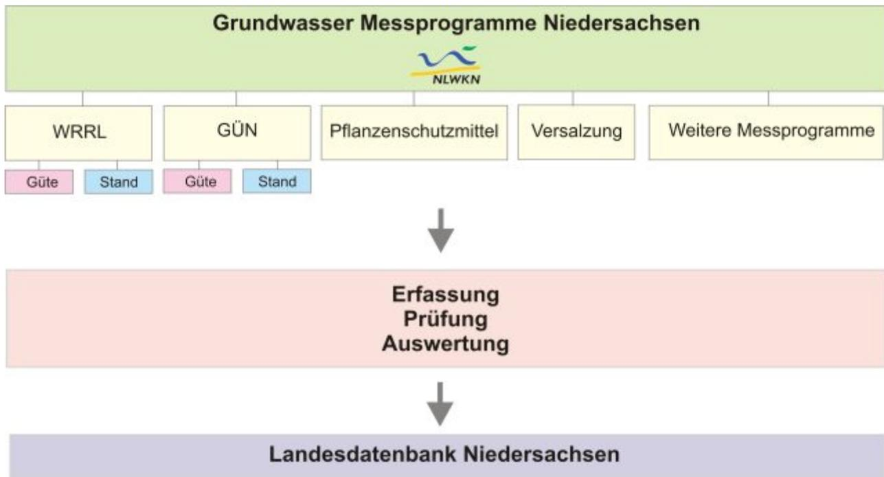
Abb. 50: Die Grundwassergüte und -stand wird in Niedersachsen im Rahmen von verschiedenen Messprogrammen umfassend überwacht. Je nach Bedarf werden hierfür Messstellen aus dem Messstellenpool herangezogen und nach Vorgaben des entsprechenden Messprogramms untersucht. Der Gesamtmessstellenpool setzt sich aus Landesmessstellen sowie Messstellen Dritter zusammen.
