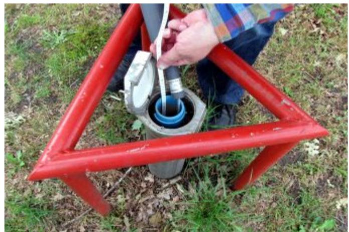
Abb. 56: Analoge Messung des Grundwasserstandes mittels Lot.
