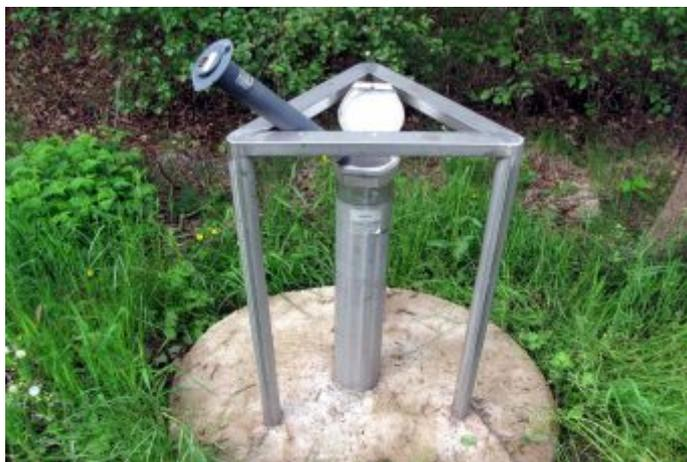
Abb. 55: Grundwassermessstelle die mit einer Datenfernübertragung (DFÜ) ausgestattet ist.
