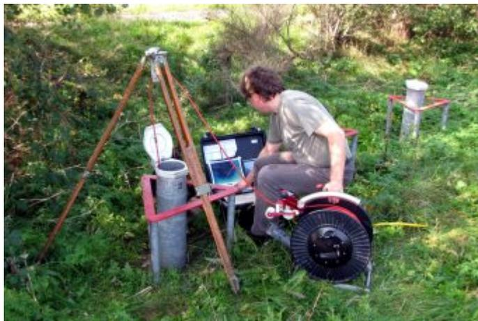
Abb. 53: Kamerabefahrung einer Grundwassermessstelle.
