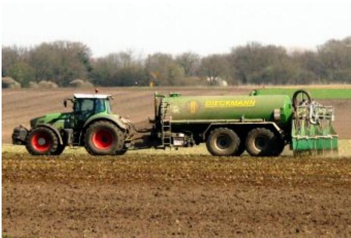
Abb. 39: Schleppschlauchdüngung.
