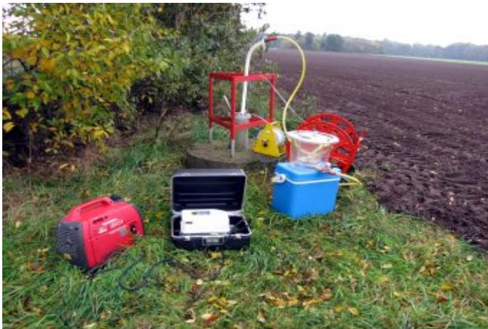
Abb. 51: Gütebeprobung an einer Grundwassermessstelle nach DIN 38402-13 (Probennahme aus Grundwasserleitern).
